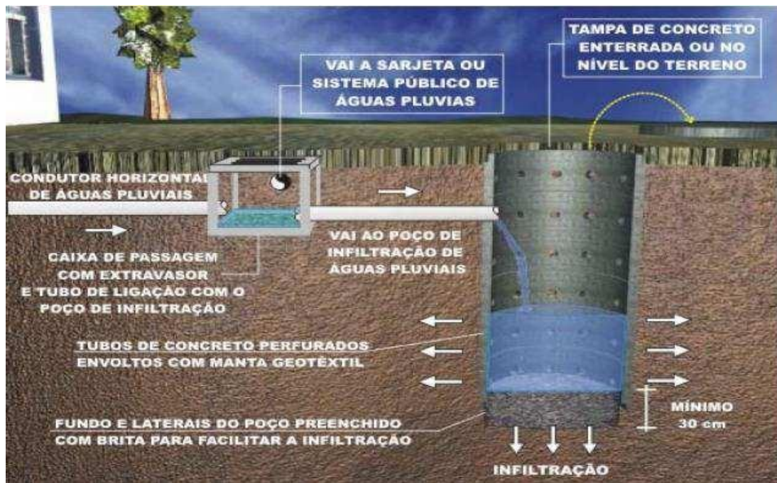
Figura 18 - Exemplo esquemático de um poço. Fonte: REIS, 2005.
