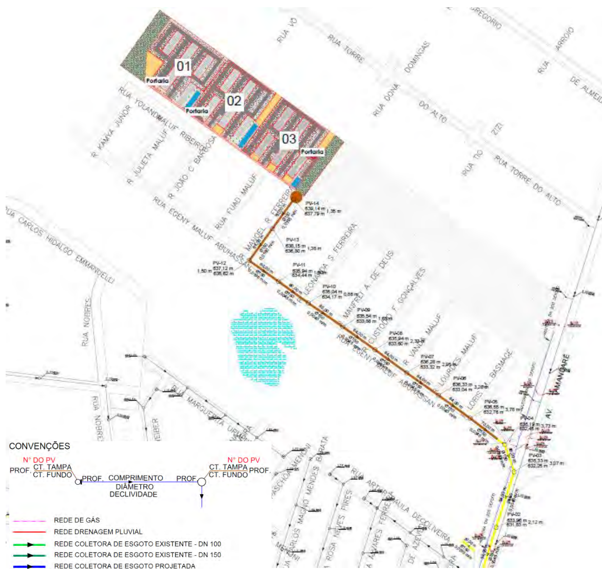
Figura 29 - Ponto de conexão do empreendimento com a rede de esgoto Fonte: Águas Guararioba S.A., 2026.
