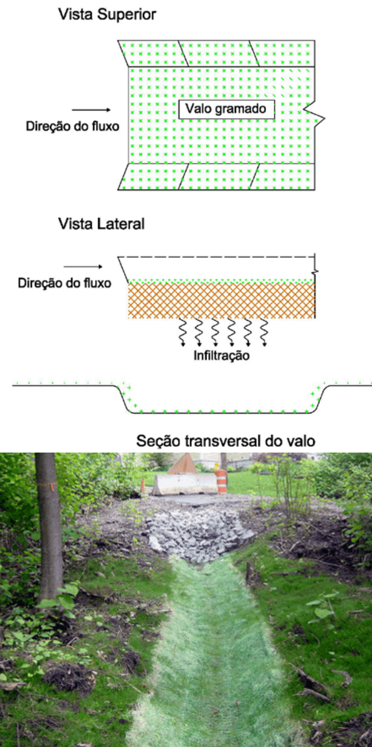
Figura 1.8 – Valo de infiltração (CIRIA, 1996).
