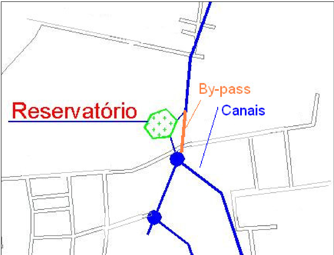
Figura 1.24 – Esquema mostrando a distribuição espacial de um reservatório off-line .
